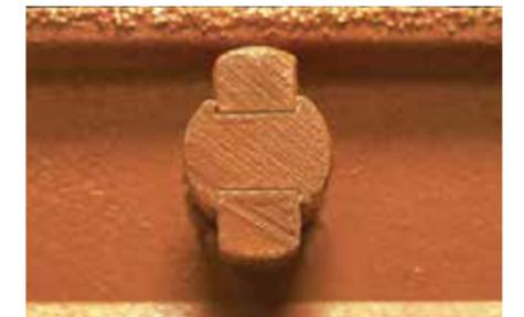
Das 3-teilige Querstabsystem unserer pultrudierten Gitterroste bildet ein starkes einheitliches System, das einfach geschnitten und bearbeitet werden kann. Der Aufbau besteht aus zwei durchgehenden pultrudierten Seitenstücken und einem zentralen Kernstück. Die Seitenstücke sind in die Tragstäbe eingekerbt und verklebt, sodass die Stäbe gleichzeitig mechanisch eingeschlossen und chemisch mit dem Steg jedes Tragstabs verbunden sind. Der Querstab
