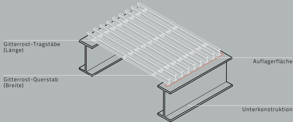
Beachten Sie bei der Planung von Projekten mit pultrudierten Gitterrosten, dass die Tragstäbe bei der Montage in die korrekte Richtung ausgerichtet sind. Die Tragstäbe tragen die Last und sind die parallel zueinander liegenden Stäbe zwischen den zwei Rostauflagern. Die Querstäbe hingegen sind die Querverbindungen zu den Tragstäben. Sie sind an den Kreuzungsstellen fest miteinander verbunden.
